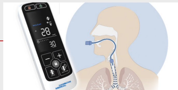
Intubación endotraqueal: el SP 270 EC-LC regula con precisión la presión del manguito (© Hamilton Medical)
